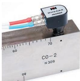
Положение преобразователя П112-5,0-8 на образце СО-2 при прозвучивании отверстия 2мм, расположенном на глубине 8мм.
