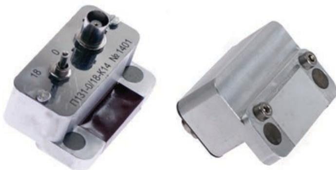
Преобразователь П131-2,5-0/18-К14 применяется для прозвучивания вагонных осей РУ1 и РУ-1Ш. Он устанавливается в канавочную часть на торце оси, что позволяет проводить неразрушающий контроль оси без снятия внутренних колец подшипников. На рабочей поверхности преобразователя установлен протектор из корундовой керамики, что обеспечивает высокую износостойкость.
