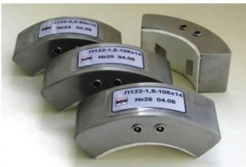
Хордовые ПЭП относятся к раздельно-совмещенным наклонным преобразователям, тип П122. Их, в основном, применяют для контроля кольцевых сварных швов трубных элементов из сталей и полиэтилена. Характерная особенность конструкции - установка точки фокуса УЗ полей излучения и приема в центр сечения сварного шва. Размеры пьезоэлементов и частоту колебаний выбирают из требования, чтобы ультразвуковое поле ПЭП захватывало всю толщину стенки трубы.
