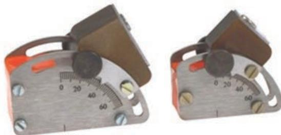
Преобразователи с изменяемым углом ввода применяются в следующих задачах ультразвукового контроля.
