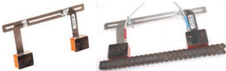
Преобразователь ПА123-1,8-65-14\*14 используется для ультразвукового контроля стыковых сварных соединений строительной арматуры.
