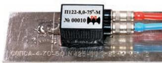
Положение преобразователя П122-8,0-75-М на СОП толщиной 4мм при максимуме эхосигнала от нижней зарубки 2\*1,3 мм.
