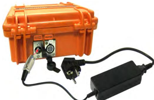
2) **Сетевой блок питания АГ114М.02.020** (на базе GS60A15-P1J «MEAN WELL») питается от сети 220В и выдает постоянное напряжение 15В ± 3% при токе до 4А.
