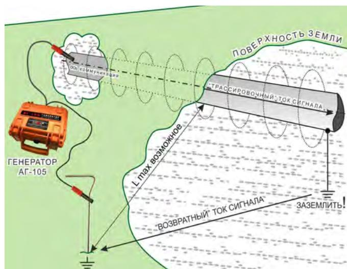
БА В ЗЕМЛЕ. Контакт с землей возможен на всем протяжении коммуникации и в любом месте. Дополнительное заземление трубы здесь бессмысленно.
