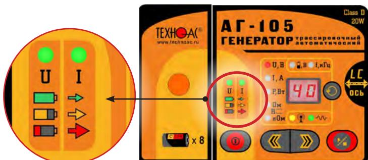
2) «I» - интенсивность ПОТРЕБЛЯЕМОГО ТОКА. Определяется по соответствию измеренного значения тока одному из трех диапазонов, специально заданных программой для текущего режима эксплуатации:
