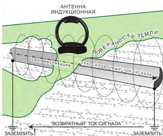
**2) Если используется встроенная передающая антенна «LC», то следует расположить корпус прибора точно над исследуемой коммуникацией (установить ориентир «LC-ось» на лицевой панели над осью коммуникации и параллельно ее направлению). Не следует пользоваться трассоискателем вблизи расположения генератора во избежание непосредственной индукционной связи (помимо коммуникации).**
