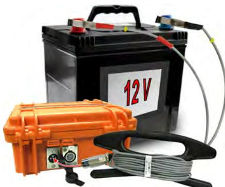
1) **Аккумулятор «12В»** (например, автомобильный) подключается при помощи «кабеля внешнего аккумулятора» (входящего в комплект поставки), где зажим с красной изоляцией соответствует положительному потенциалу «+», зажим с черной изоляцией соответствует отрицательному потенциалу «-».
