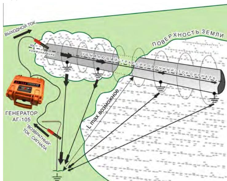
**Примечание для «бесконтактных» способов подключения («LC» / «AH» / «клещи»).**
