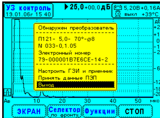
Рис. 9.4.1.1. Результат считывания данных из преобразователя.
