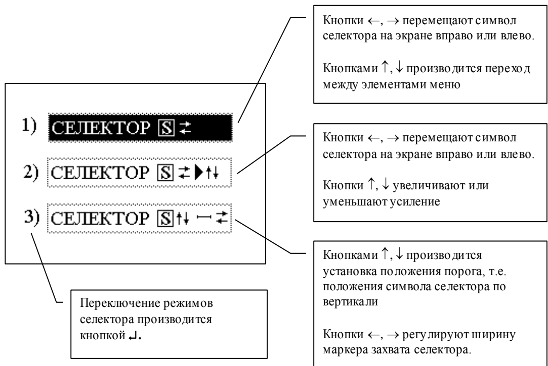
Рис. 6.3.2. Режимы управления селектора.
