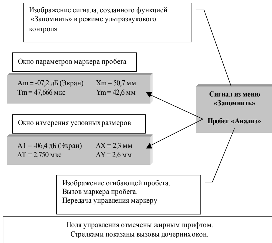
Рис. 8.4.1. Структура меню «Функции» в режиме просмотра файлов ультразвукового контроля.
