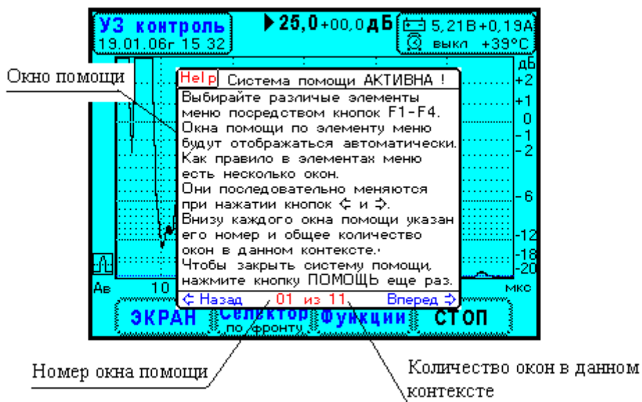
Рис. 9.3.1. Окно контекстной помощи на экране прибора.
