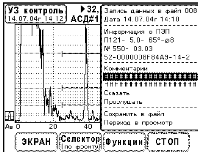
Рис. 9.5.5.1. Меню записи данных ультразвукового контроля.
