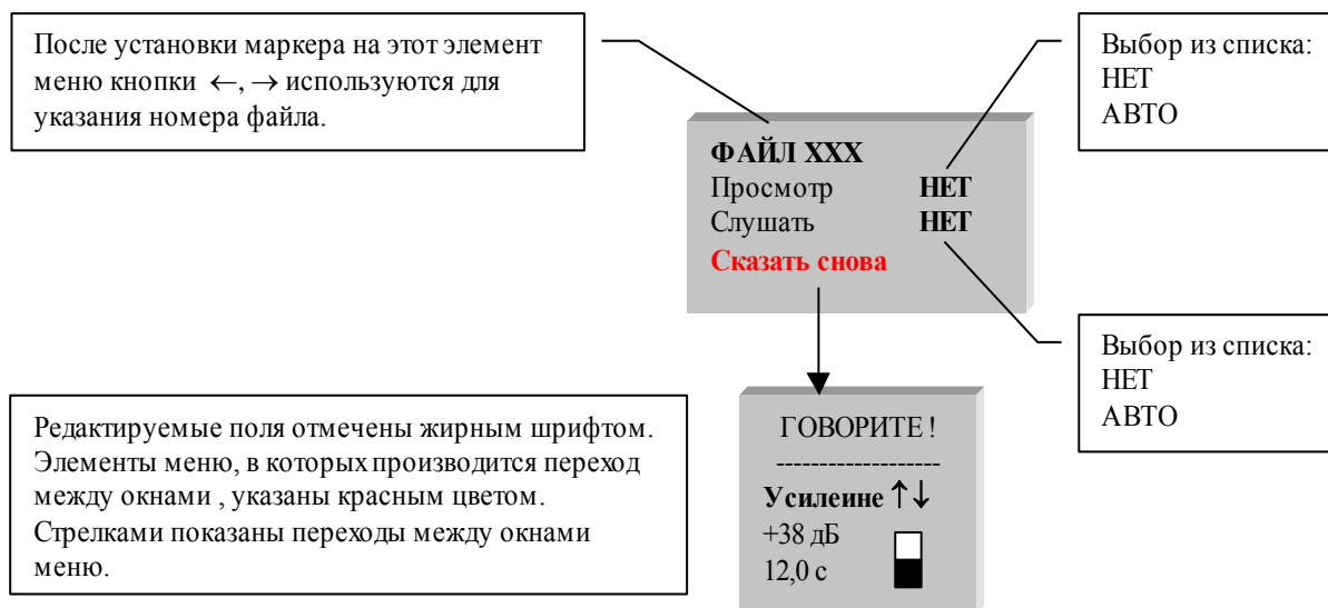
Рис. 8.1.1. Структура управляющего меню «Файл XXX».
