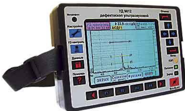
Рис.1.1. Ультразвуковой дефектоскоп УД9812.
