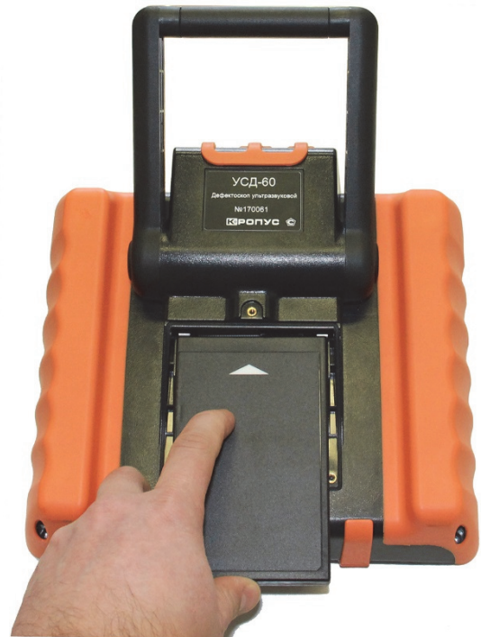
Рис.1-4 Установка нового аккумулятора
