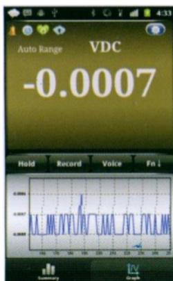
После нажатия кнопки
