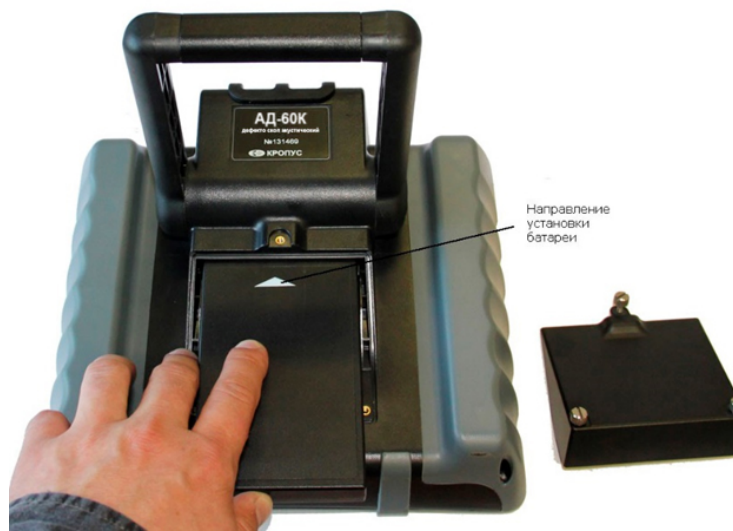
Рис 1-4 Установка нового аккумулятора
