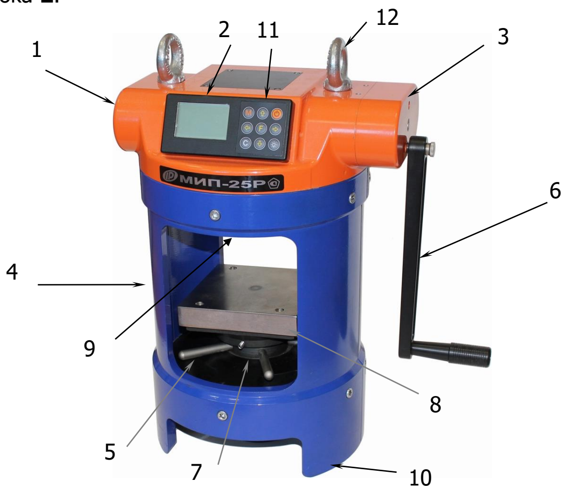
Рисунок 1 – Общий вид приборов модификаций МИП-25Р и МИП-50Р
