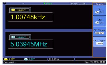
Двухканальные 6-разрядные частотомеры входят в перечень базовых функций всех моделей осциллографов серии TBS1000B-EDU.
