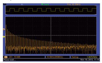
Быстрый доступ к функции БПФ с помощью расположенной на передней панели специальной кнопки.
