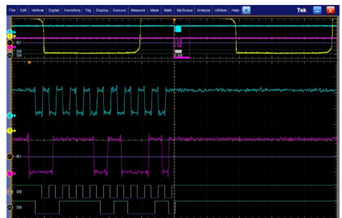
Встроенные цифровые каналы обеспечивают привязанное к единой шкале времени отображение аналоговых и цифровых сигналов для отладки системы.
