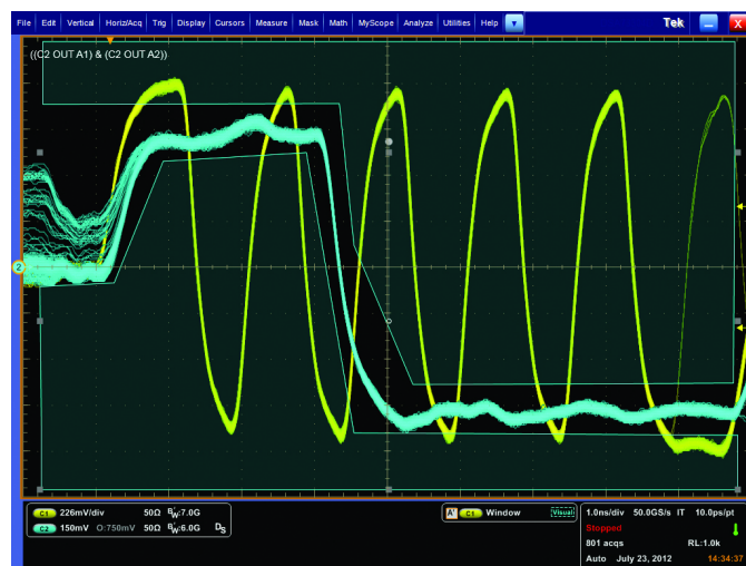
Шина памяти DDR. Визуальный запуск используется для выделения неперiodических событий в пакетах записи по определенной последовательности битов в памяти DDR3. Событием для запуска является пакет записи DQ (код 11000000), если сигнал DQ начинается с напряжения, отличного от любого из трех состояний. К сигналам шины памяти DDR относятся тактовая частота, стробирующие импульсы и пакеты данных, имеющие разную амплитуду.
