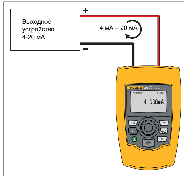
Рисунок 6. Соединения для измерения тока в мА
