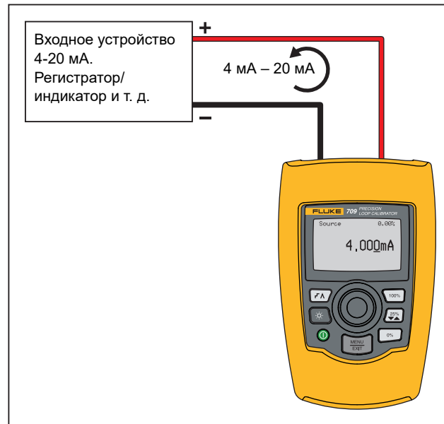
Рисунок 4. Соединения источника тока в мА
