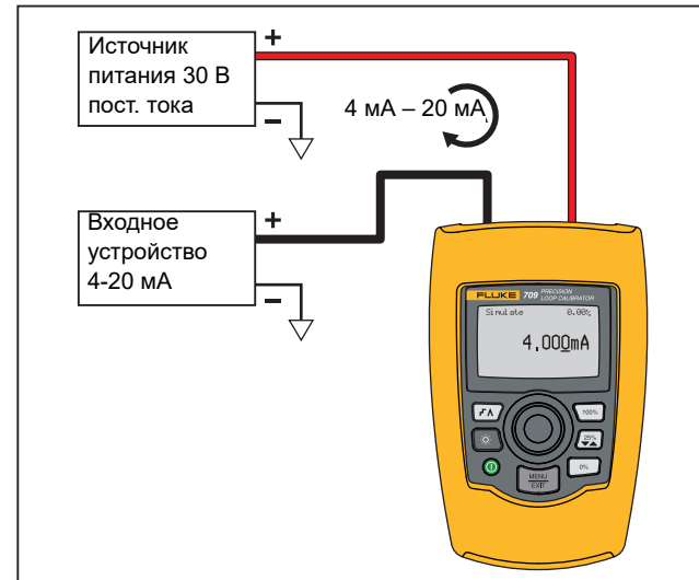
Рисунок 5. Соединения для моделирования тока
